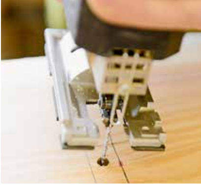
Die Stichsäge im Bohrloch ansetzen.
