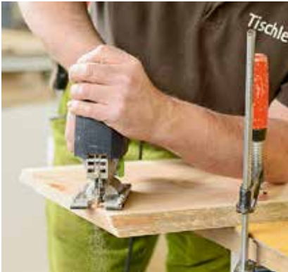
Das sogenannte „Ausklinken“ sorgt für einen besseren Stand des Stuhls.
